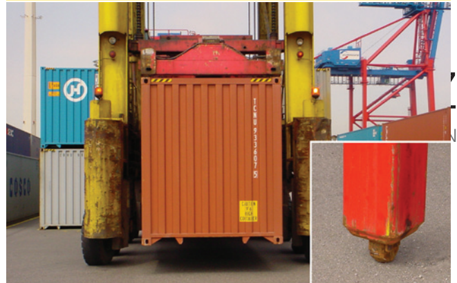
ABBILDUNG 5: HAMBURGER HAFEN, PUNKTBELASTUNG & HUBGERÄTE AUF EINER DICHTEN ASPHALT-DECKSCHICHT AUF BASIS VON NYNAS ENDURA Z2.
