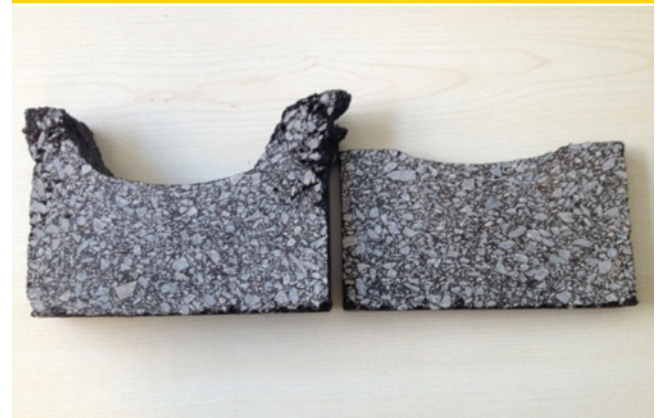
ABBILDUNG 3: SPURBILDUNGSWIDERSTAND VON NYNAS ENDURA Z2 (RECHTS) IM VERGLEICH ZU BITUMEN 40/60 3
